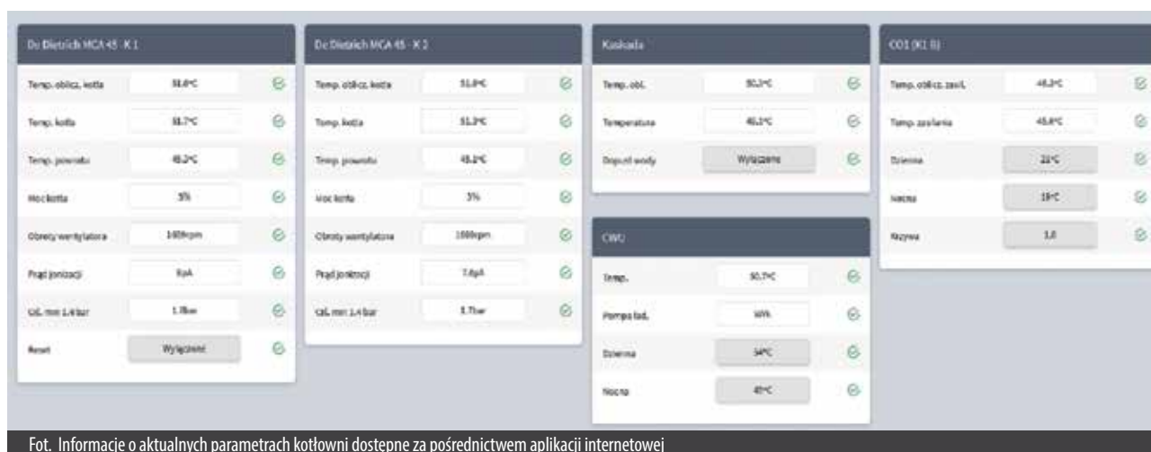
Fot. Informacje o aktualnych parametrach kotłowni dostępne za pośrednictwem aplikacji internetowej
