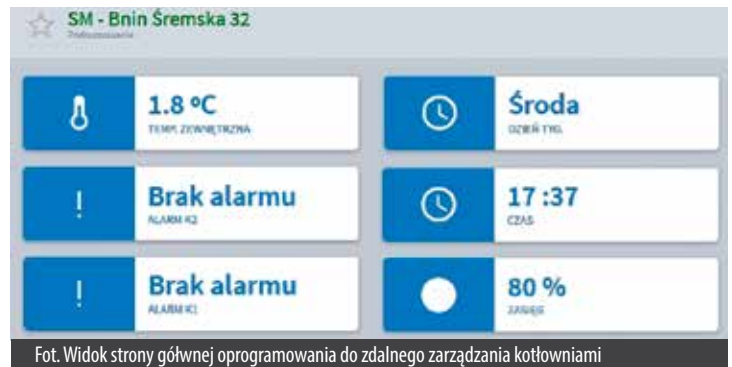
Fot. Widok strony głównej oprogramowania do zdalnego zarządzania kotłowniami
