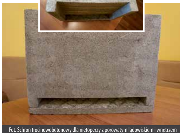
Fot. Schron trocinobetonowy dla nietoperzy z porowatym lądowiskiem i wnętrzem
